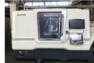
ターニングセンター 最大加工径：φ366 最大加工長：705 X-Y-Z移動量：260×±50×795 ベッド上の振り：920 クロススライド上の振り：742
