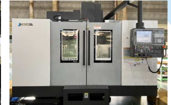
立形マシニングセンター 最大加工物：1,200×560 X-Y-Z移動量：1,300×610×560 最大積載質量：1,500kg
