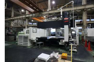
門形五面加工機 最大加工物：1,400×2,600×1,200 X-Y-Z-W移動量：1,900×3,100×715×500 最大積載質量：10,000kg
