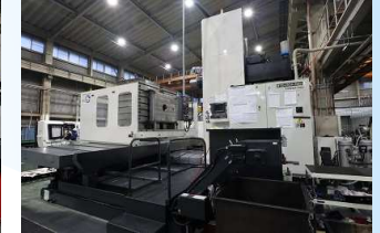
横中ぐりフライス 最大加工物：2,000×1,600×2,000 最大振り回し：φ2,800 X-Y-Z移動量：3,000×2,300×1,600 主軸繰り出し移動量：700 最大積載質量：20,000kg
