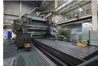
門形フライス 最大加工物：1,700×6,000×1,400 X-Y-Z移動量：2,400×6,500×1,780 最大積載質量：4,000kg/m
