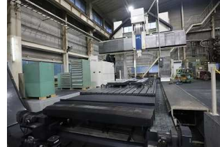
門形五面加工機 最大加工物：2,300×5,500×1,900 X-Y-Z-W移動量：6,500×3,900×900×1,000 最大積載質量：30,000kg
